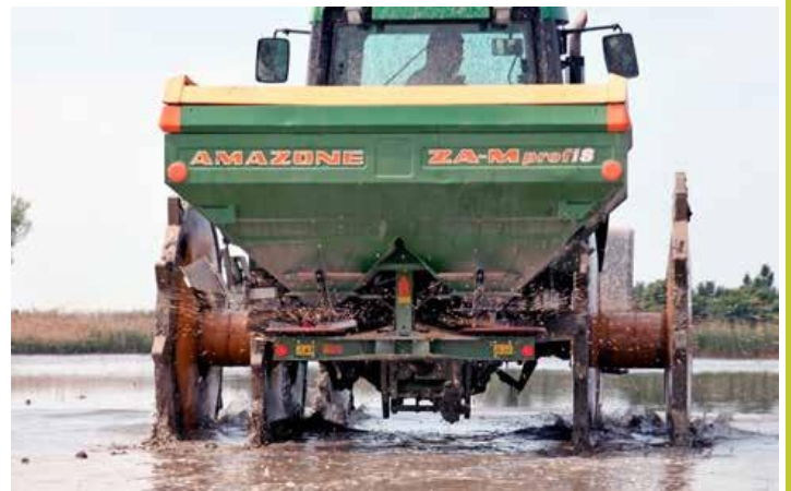
Le semis s'effectue toujours à la volée, à l'aide d'un épandeur d'engrais. Les semences sont mises à tremper environ 48 heures. Autour de 200 à 220 kg de grains sont épanchés par hectare.
