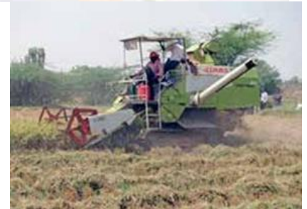
Claas Dominator 85 équipée pour la récolte du riz : Claas fabrique des moissonneuses spécifiques pour le riz (les Crop Tiger) dans son usine de Bangalore (Inde).
