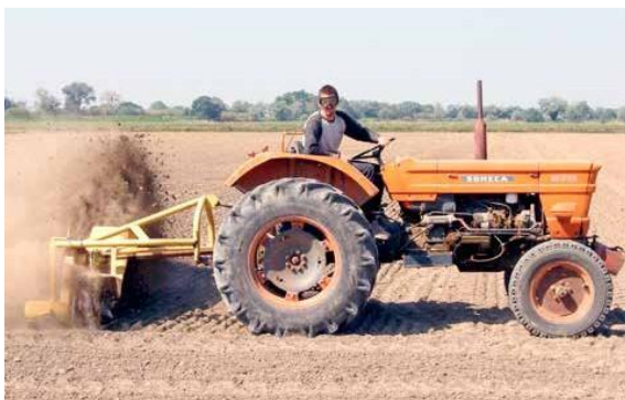
Derrière le Someca 670, la cureuse de fossés est employée pour creuser des rigoles dans la rizière avant sa mise en eau. Elles favorisent la répartition dans la parcelle, et servent de fossés lorsqu'il est nécessaire d'évacuer l'eau.
