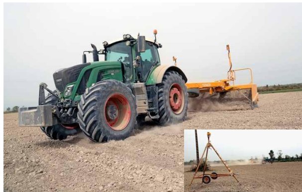
Aplanissement d'une rizière avec une lame niveleuse à guidage laser. Sur le trépied, l'émetteur laser est réglé à une hauteur de référence. Sur la lame niveleuse, deux récepteurs commandent l'ajustement de la hauteur de la lame. De son côté, le tracteur est guidé par GPS pour optimiser son parcours dans la parcelle.
